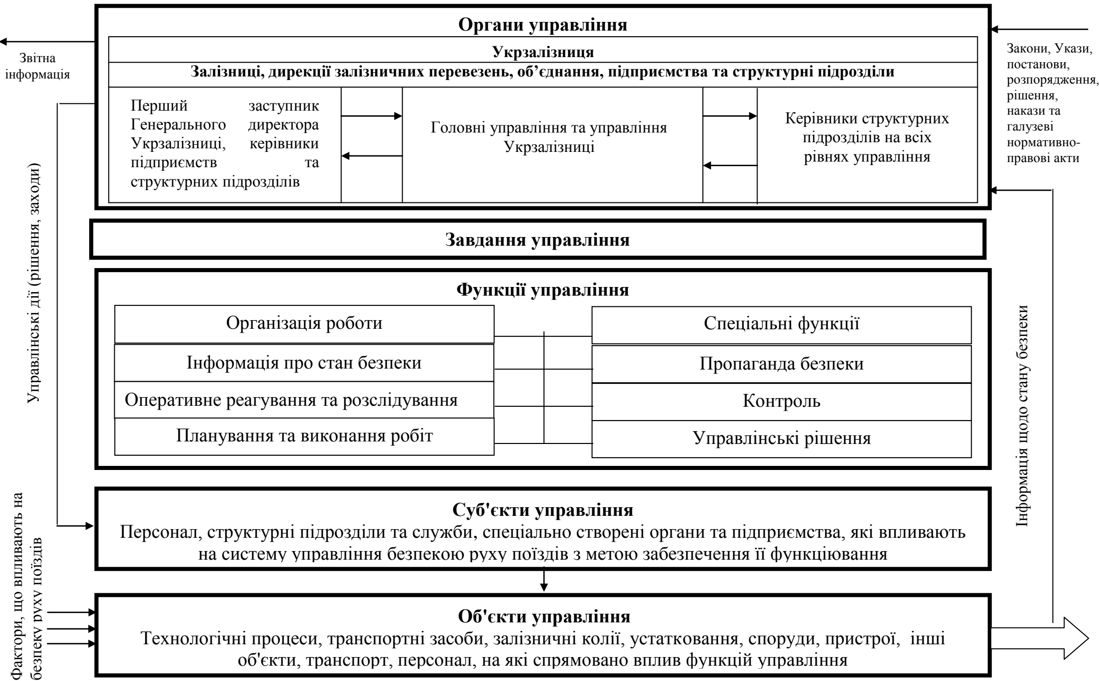
Рис.1 Структурно-функційна схема управління безпекою руху поїздів в Укрзалізниці
