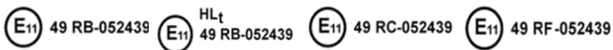
Рисунок 4. Приклади маркування дзеркал а) - г) і пристрою заднього огляду без дзеркала г) відповідно до законодавства ЄС
