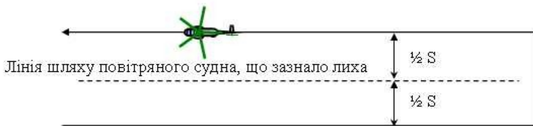
Мал. 4. Пошук з обстеженням лінії шляху з поверненням (TSR)
